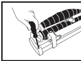
19. Infine, monta la barra laterale avvitando le due viti che stanno davanti e sul retro della tenda.
